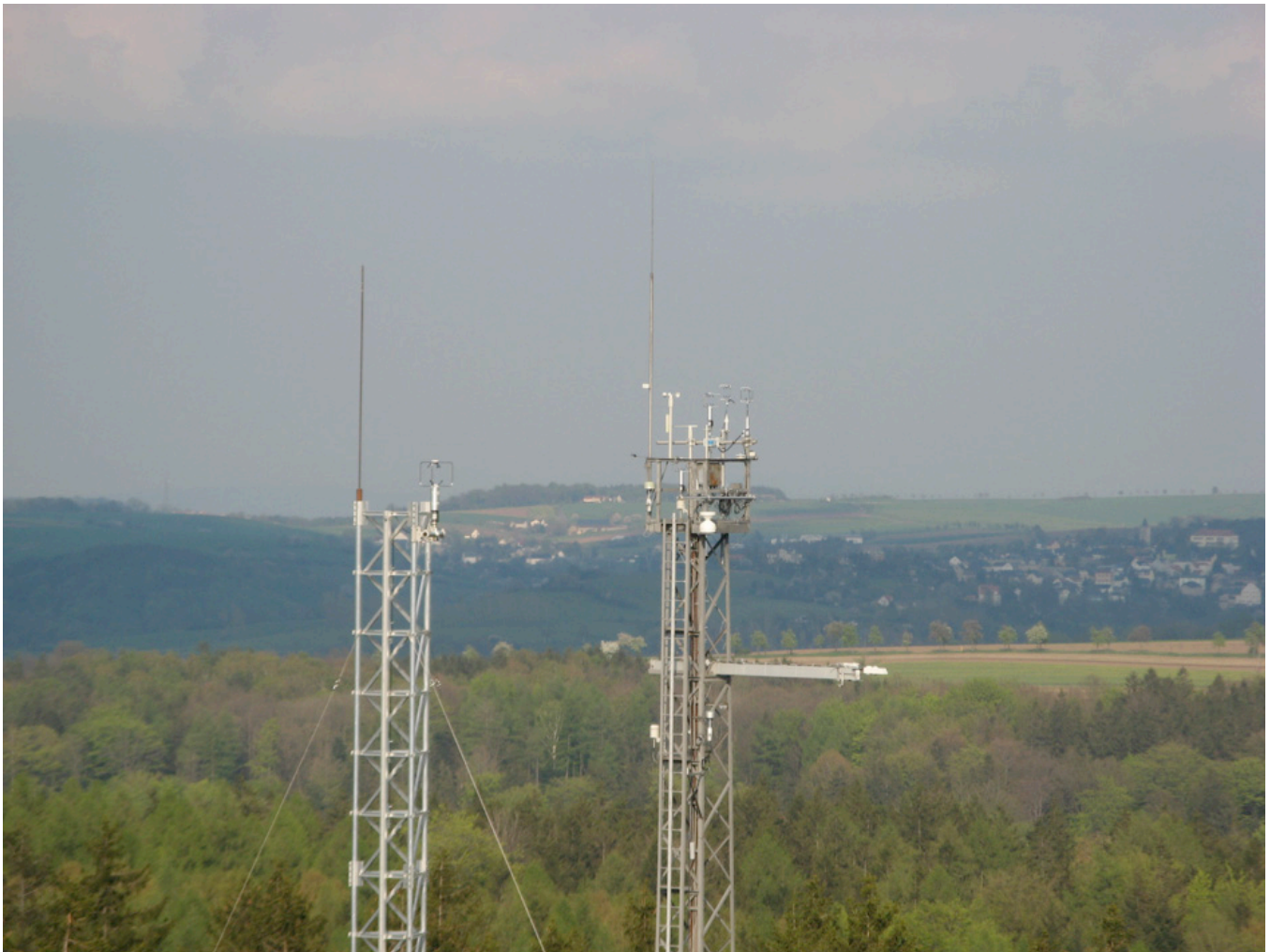
Messtürme der TU Dresden (Professur für Meteorologie) im Tharandter Wald zur Bestimmung der Wasser- und Kohlenstoffflüsse. Foto: Ronald Queck
